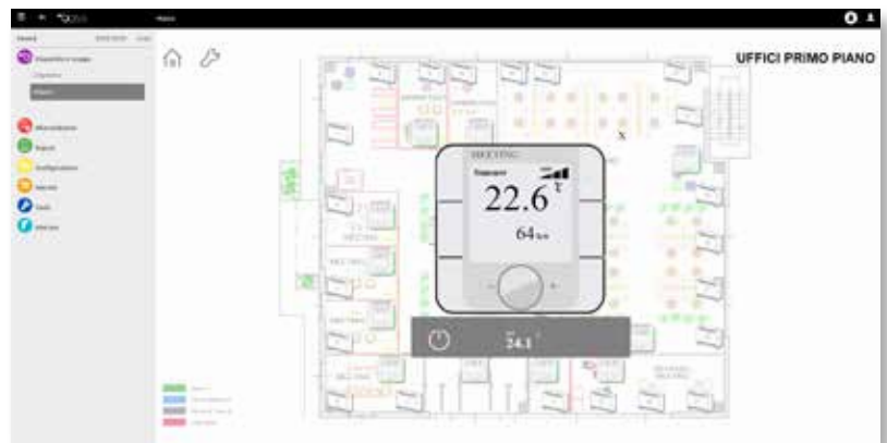
Planimetrie navigabili per il controllo dei setpoint ambiente e degli orari di funzionamento
